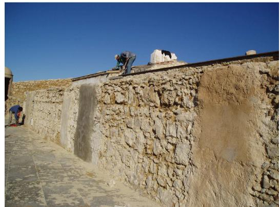
Fig. 10 - Argamassas com diversas pozolanas: provetes e painéis experimentais
