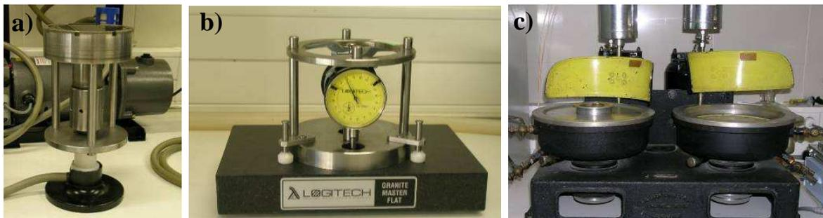
Figura 22 – a) Acessório do equipamento de desbaste, b) instrumento de calibração, c) discos de polimento.
