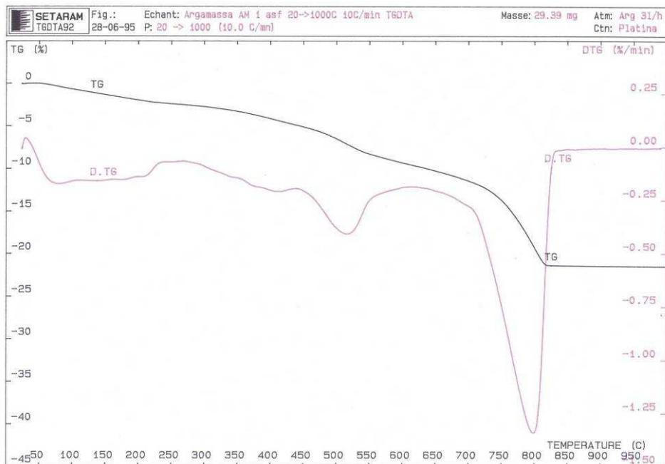
Figura 78 - Termograma da argamassa AM 1 (Castelo de Amieira do Tejo). O registo a preto corresponde à curva TG e a vermelho à curva DTG.
