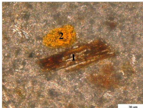
Figura 60 – AM 2: Grão de biotite (1) e substância neoformada pontualmente dispersa no ligante de cor amarela-dourada. Luz paralela.
