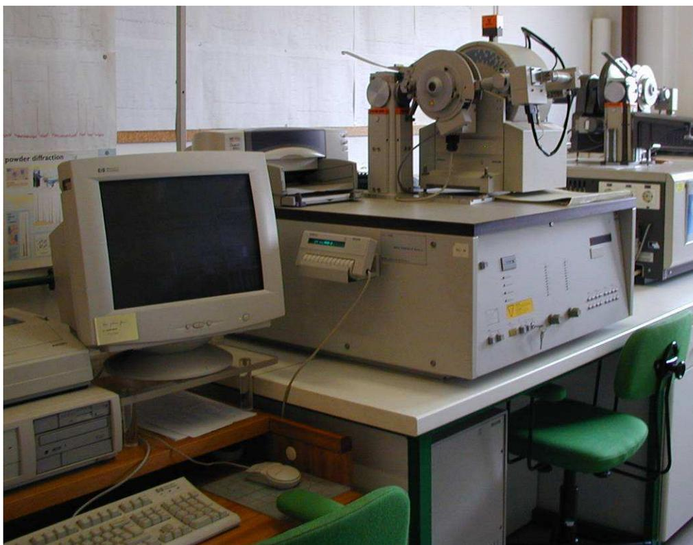
Figura 3 – Difratómetro de raios X, Philips X' Pert.
