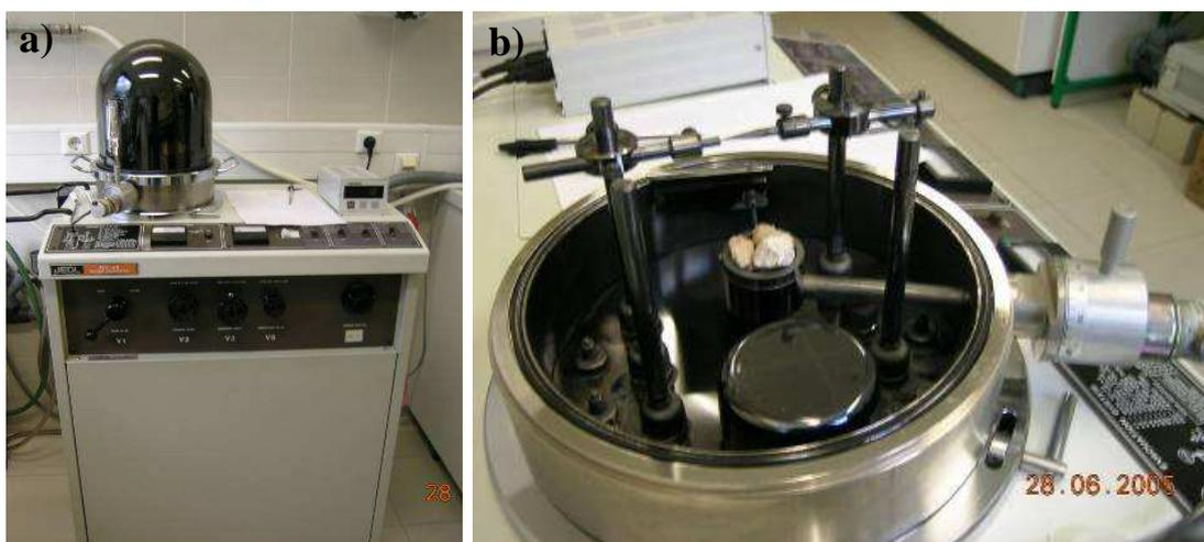
Figura 23 – a) Equipamento de metalização de amostras com carbono, b) pormenor do equipamento da fotografia anterior com uma amostra em fractura fresca.
