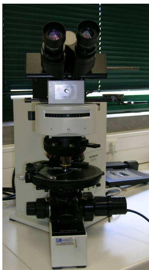
Figura 2 – Microscópio petrográfico, marca Olympus.
