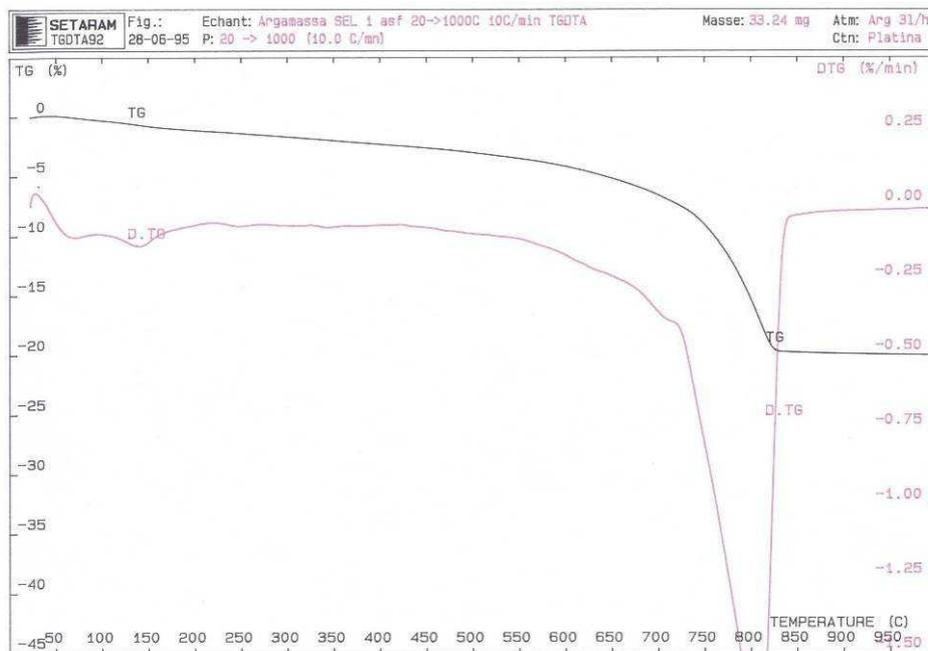
Figura 74 – Termograma da argamassa SEL 1 (Sé de Elvas). O registo a preto corresponde à curva TG e a vermelho à curva DTG.
