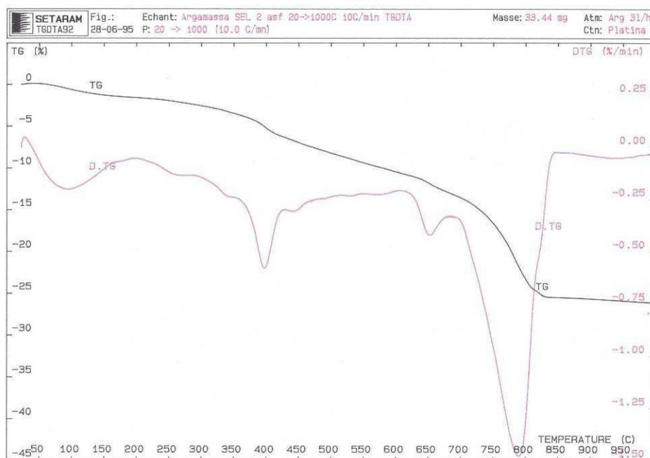
Figura 75 – Termograma da argamassa SEL 2 (Sé de Elvas). O registo a preto corresponde à curva TG e o vermelho à curva DTG.
