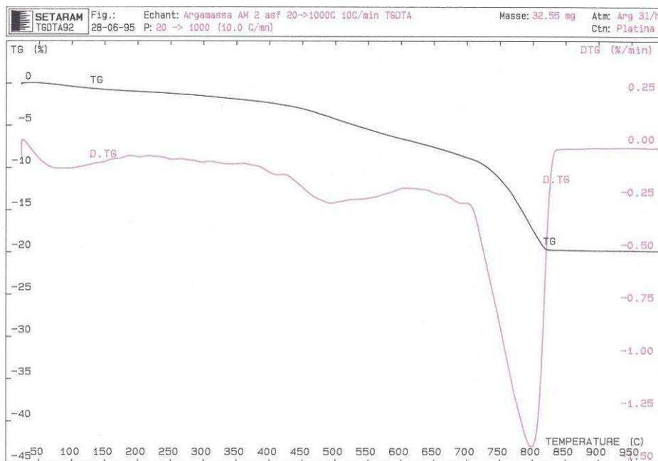
Figura 79 - Termograma da argamassa AM 2 (Castelo de Amieira do Tejo). O registo a preto corresponde à curva TG e a vermelho à curva DTG.
