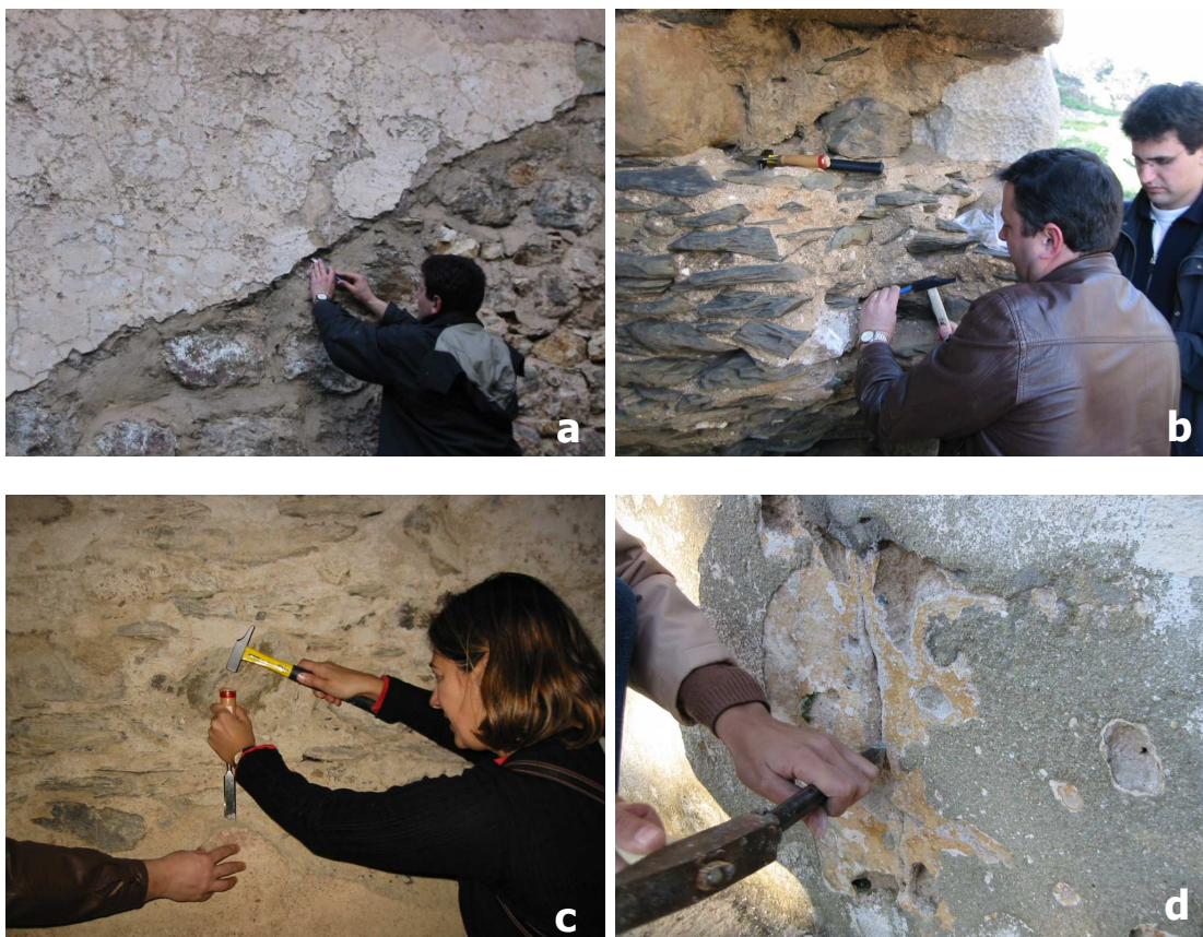
Fig. 9 – Recolha de amostras e estado de conservação de alguns casos de estudo: a) Castelo de Amieira do Tejo; b) Torre do Rio (Mértola); c) Criptopórtico (Mértola); d) Forte Santa Marta (Cascais)
