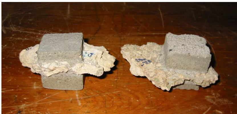
Fig. 1 – Pormenor de amostras preparadas com a argamassa de confinamento sobre as duas faces mais paralelas das amostras
